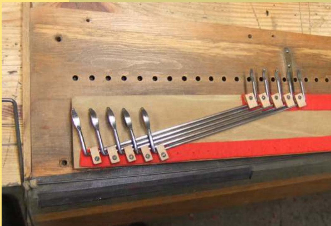
De stangen van het oktaafkoppel worden op hun plaats gezet.
