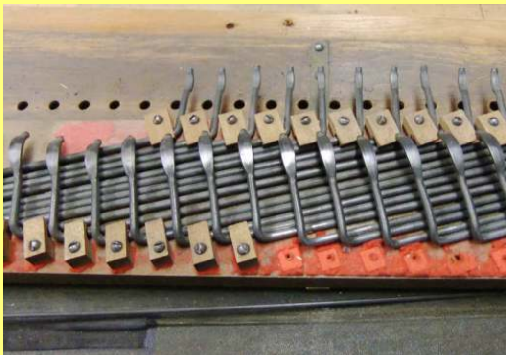
Het meeste vilt is verdwenen onder de stangen waardoor ze niet meer op hun plaats worden gehouden
