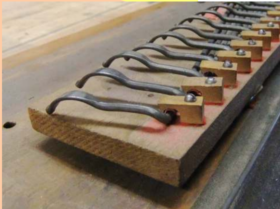
Ook het vilt in de geleiders is verdwenen, de stangen liggen vrijwel los en hebben veel te veel speling
