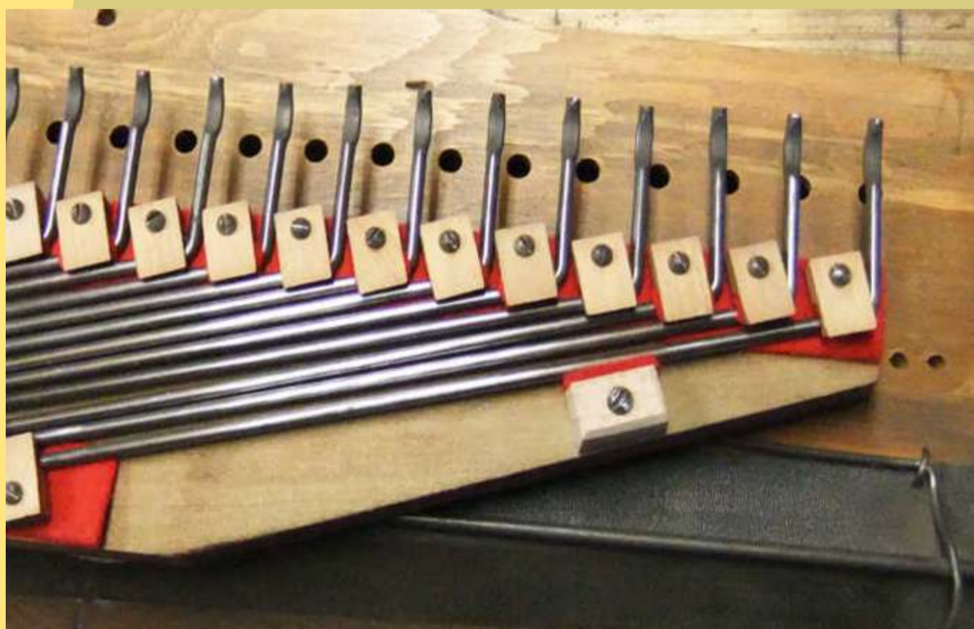
De stangen van het oktaafkoppel worden op hun plaats gezet.
