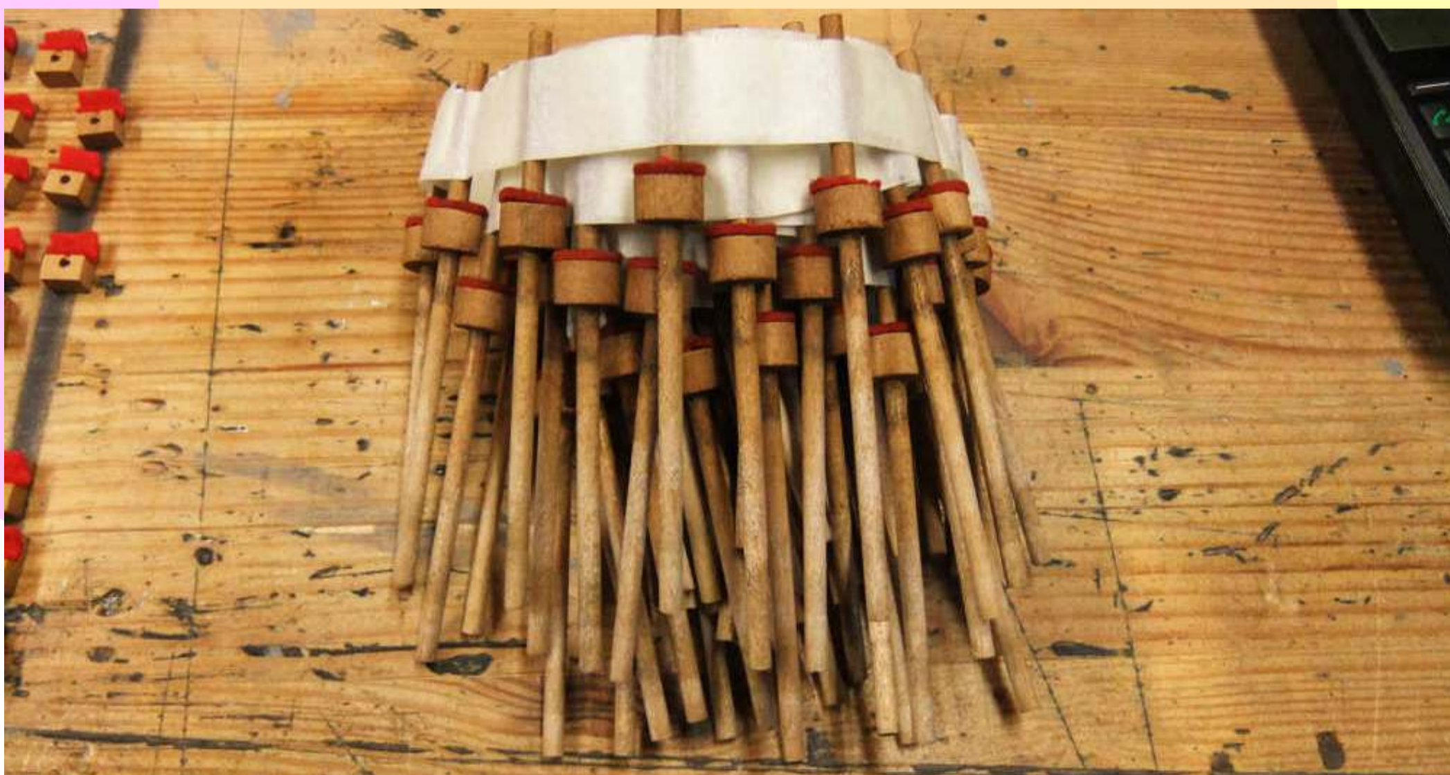
De ventielstoters moeten op volgorde blijven en weer op hun oorspronkelijke positie worden teruggeplaatst.
