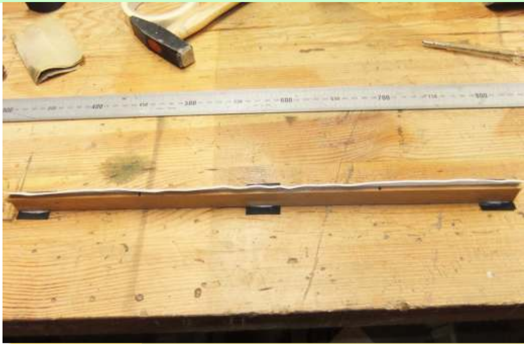
Het lekkende registerventiel was niet kromgetrokken
