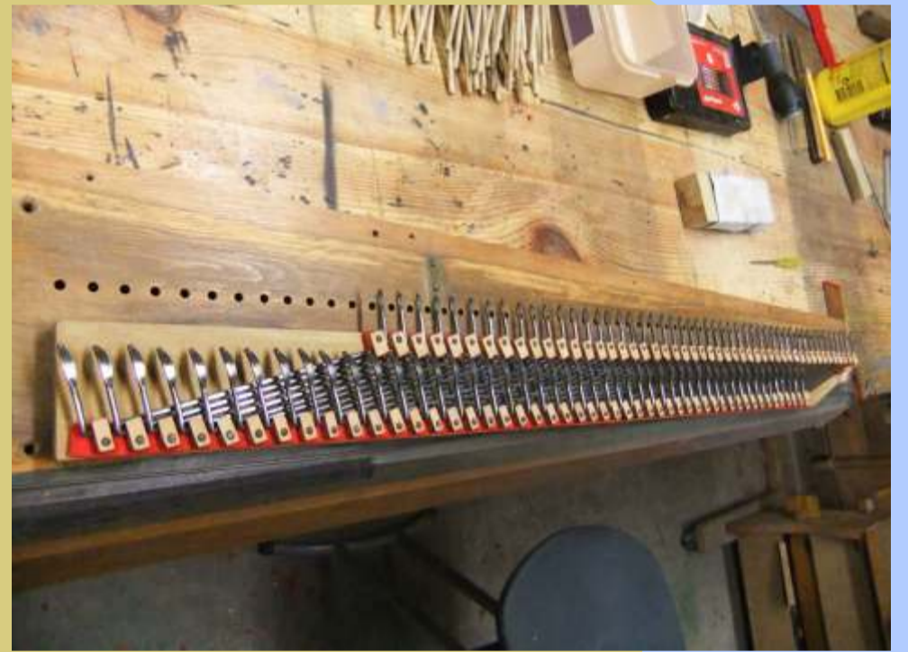
En een paar uur verder is het oktaafkoppel gereed.
